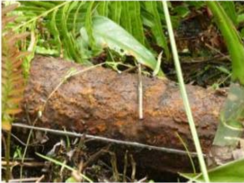
Imagen 8: Ductos corroídos en Pacaya Samiria. Fuente: R. Segovia
